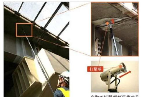
図一技術イメージ（打音検査システム）
