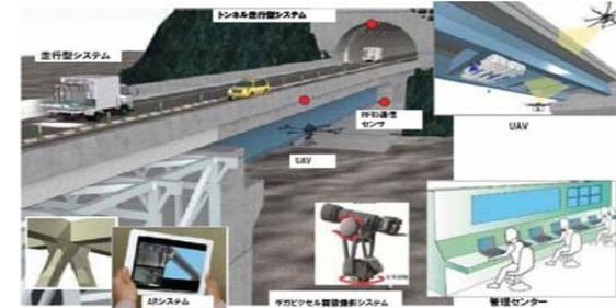
インフラの調査・記録保存への光学的計測手法の活用として、①3Dレーザースキャナによる構造物の3次元形状計測、②SfM・多視点画像3Dモデル構築技術、③UAV活用による多視点画像SDモデル構築技術、④ギガピクセル画像による遠方目視調査、がある。
