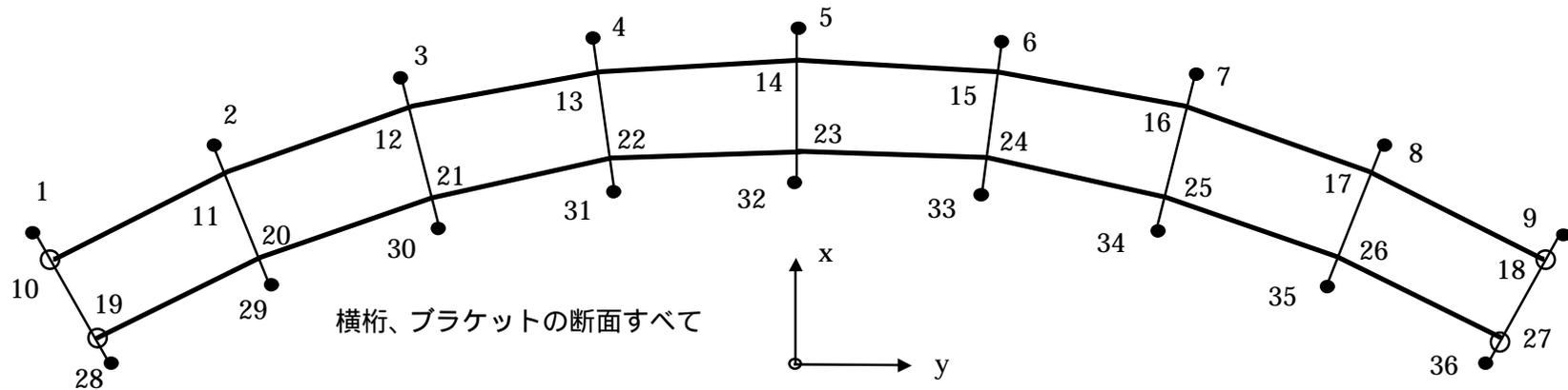
図 - 3 曲線格子桁の骨組図
