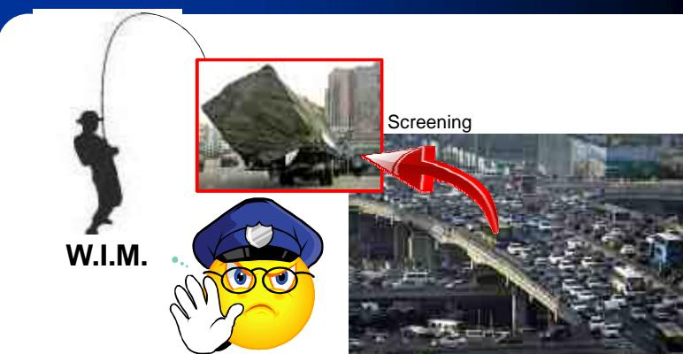
超重量車両をスクリーニングして、たとえば台貫に誘導する
