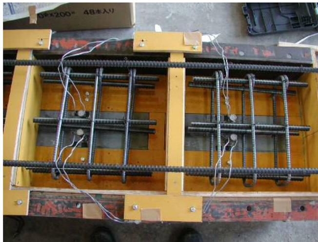
押抜き試験体の型枠
