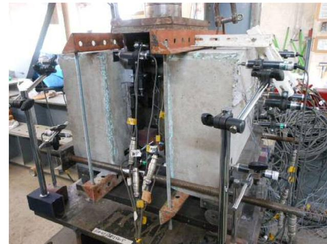
押抜き試験の状況(スタッド軸径19mm)
