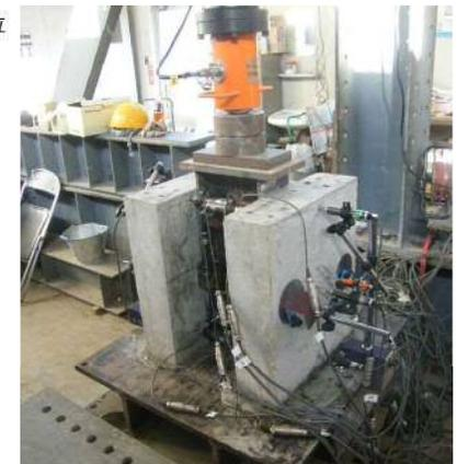
押抜き試験における計測状況
