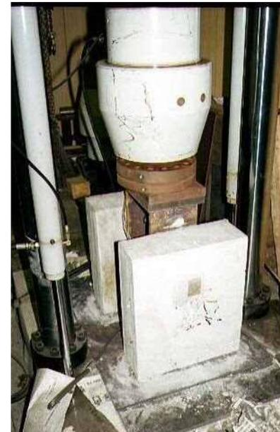
通常の疲労押抜き試験
