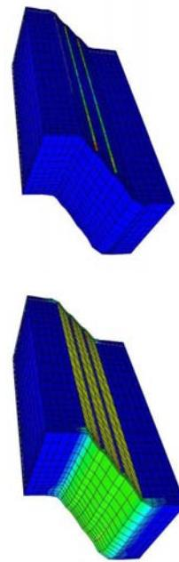
ひずみ分布 (主ひずみ)
